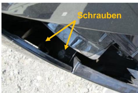
Jetzt können die 2 Schrauben in jeder Kotflüglecke herausgedreht werden. Es ist ein wenig eng um dort drinnen zu schrauben. Es lässt sich mit kleiner Ratsche, Gelenk und Verlängerungen und ein wenig Geduld aber lösen. An die hintere kann man auch von unten durch den gelösten Innenkotflügel herankommen.
