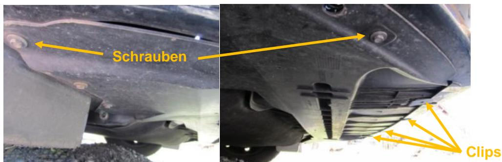
Jetzt sind alle Schrauben und Halteclips gelöst. Nun nur noch den Clip rechts und links lösen und man hat die komplette Frontstoßstange in der Hand. Am einfachsten wenn man diesen Schritt zu zweit durchführt, denn die Front ist sperrig. Nun noch die Steckverbindung trennen und dann ist die Frontstoßstange komplett demontiert.
