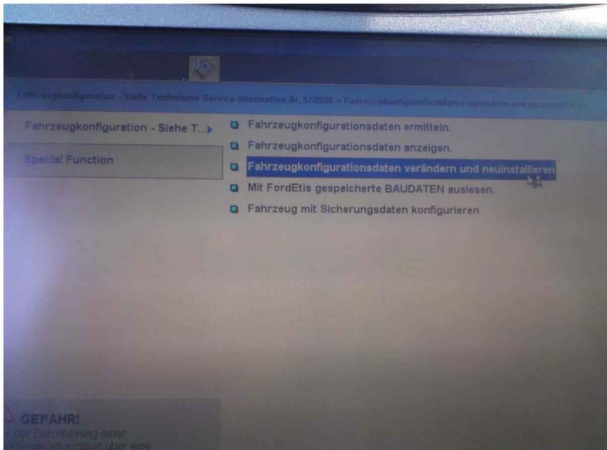
Jetzt könnt ihr die Fahrzeugkonfiguration sehen, in dieser Datei solange nach unten scrollen, bis der Punkt "Geschwindigkeitsregelanlage" auftaucht, dort einfach die Registerkarte öffnen und "Geschwindigkeitsregelanlage" auswählen.
