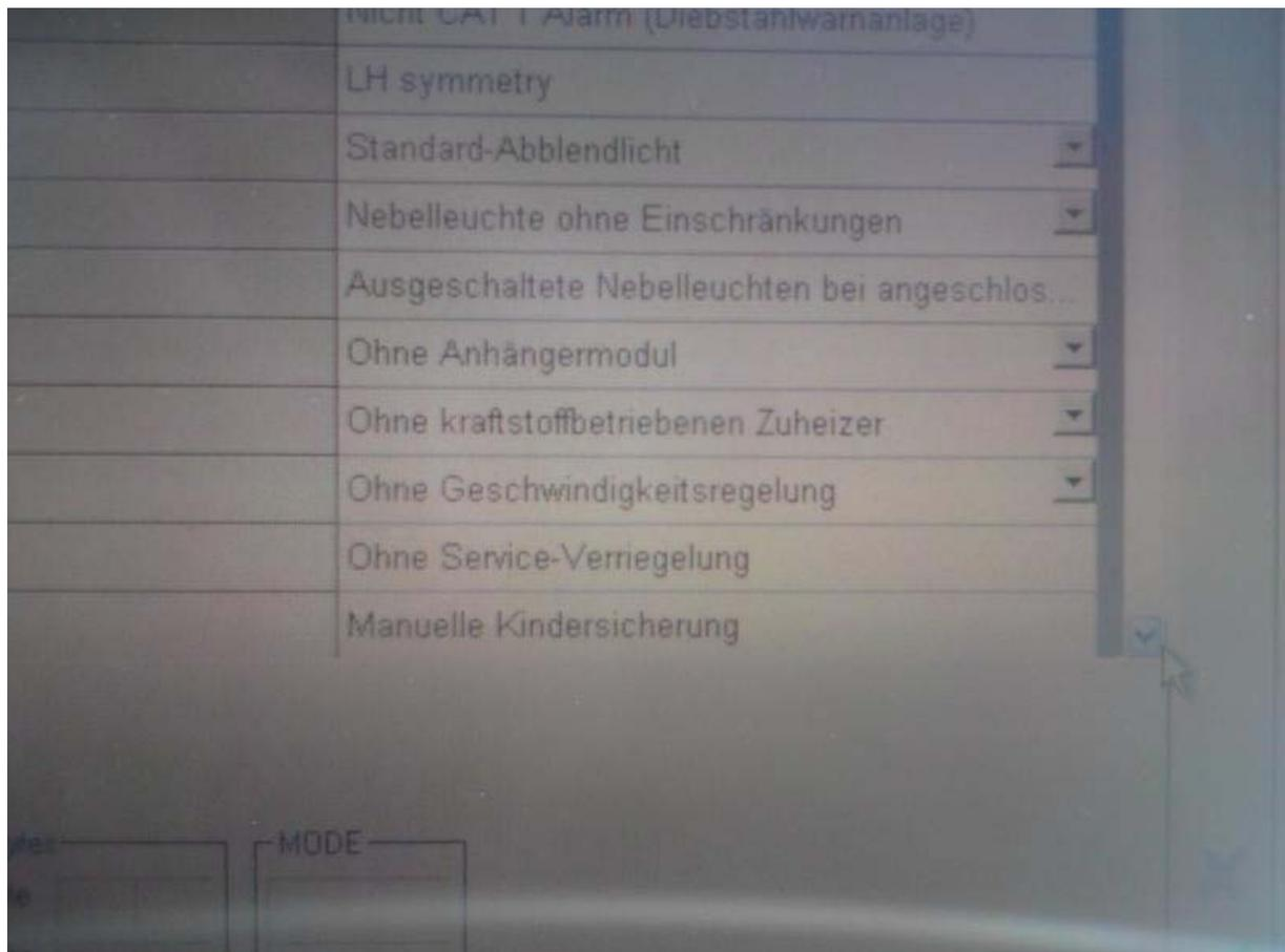
Dann alles mit dem grünen Häkchen rechts speichern und bestätigen, anschließend die Konfigurationsdatei vom IDS wieder ins Fahrzeug herunterladen und schon ist die Programmierung geglückt.
