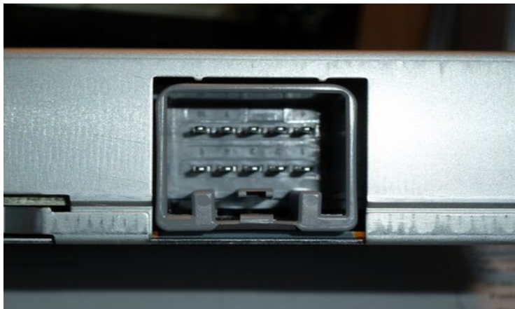
Abbildung 1: Anschlußterminal Ford DAB Box
