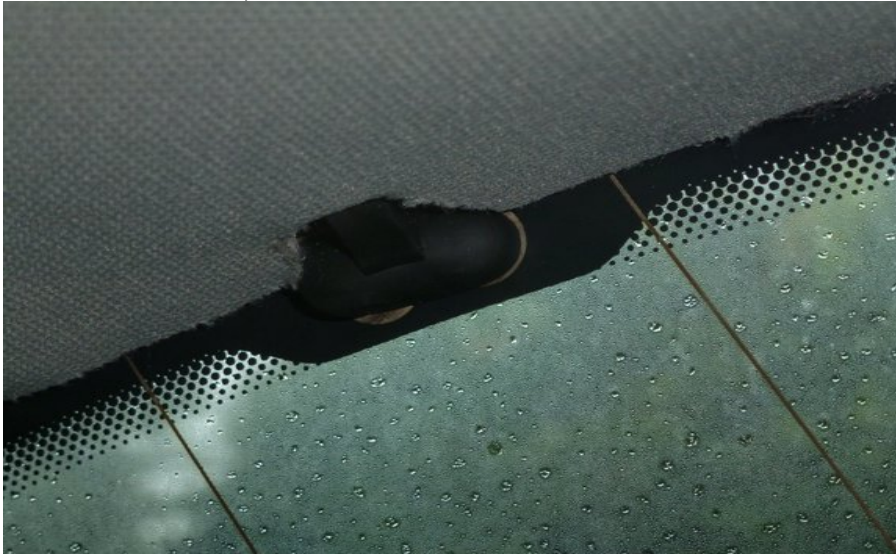
Abbildung 3: Einbauort Antennenverstärker links
