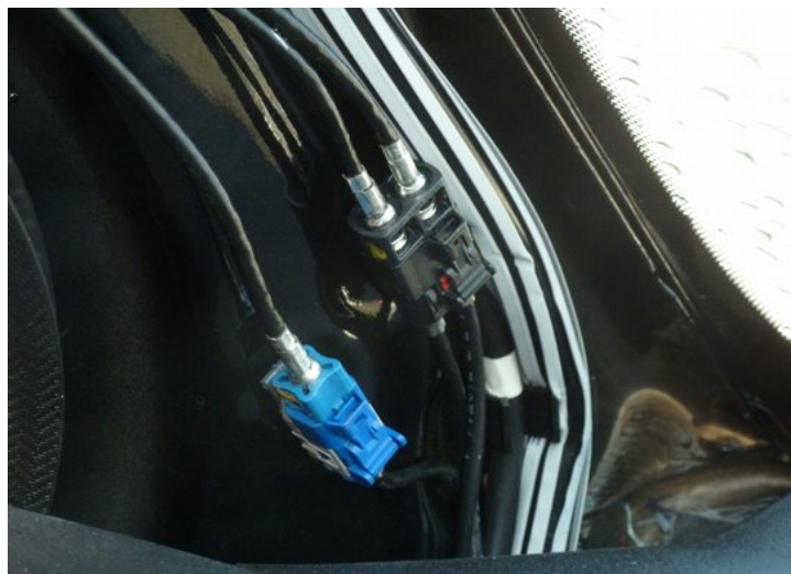
Abbildung 4: Antennenanschluß A Säule links
