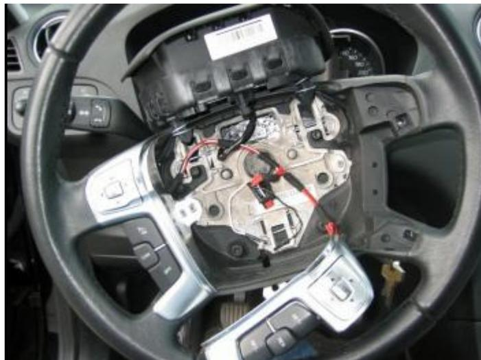
Nun die beiden Torque-Schrauben lösen und entfernen, welche die Bedieneinheiten noch am Lenkrad festhalten. Beide Bedienelemente inklusive Kabel entfernen.(Das alte Kabel ist in einer Gummiführung, wo das neue bitte auch wieder reingehört).
