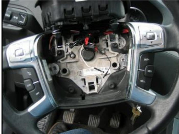
Den großen Stecker einrasten - Kabel in die Gummiführung - Flachstecker auf den runtergeklappten Airbag stecken. Alles auf korrekten Sitz und Passgenauigkeit überprüfen - Airbag in die Klammern drücken
