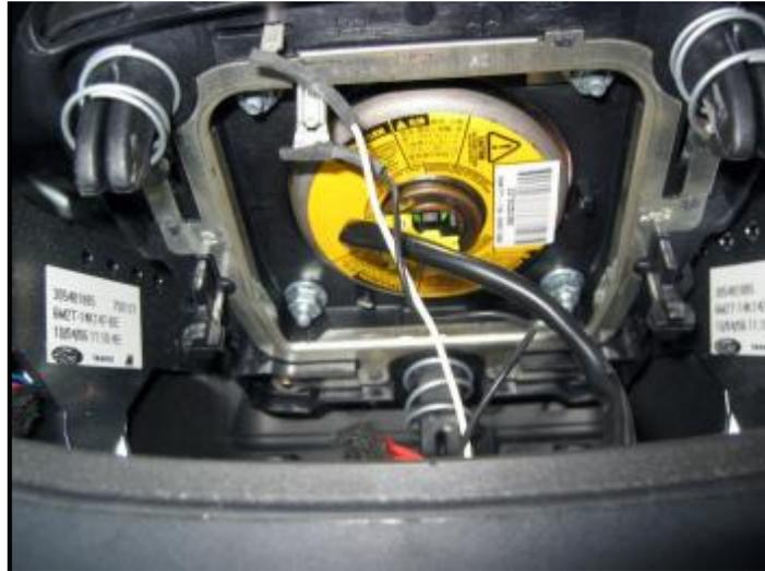
**Den Airbag am Lenkrad belassen !!!!! und nur zur Seite legen (am besten nach oben bei gerade stehendem Lenkrad)**
