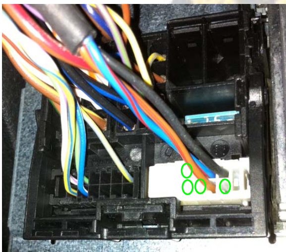
Bild 3: Blick auf den originalen Stecker – Analoge Betrachtung wie Bild 1. Man sieht die nicht vorhandenen PIN-Belegungen 3,9,10 & 12.
