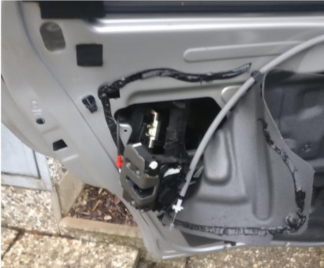
Bowdenzug für Außentürgriff (rot) ausklipsen und Schlossträger vom Schloss entfernen.
