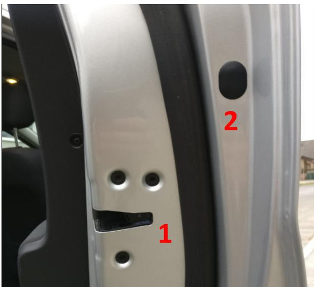
Danach kann der Haupttürgriff entfernt werden. Darunter befindet sich die zweite Schraube, mit der der Schlossträger fixiert ist.
