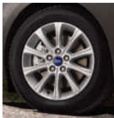
Leichtmetallräder 6½ J x 16 im 10-Speichen-Design (Serienausstattung für Titanium, Wunschausstattung und Zubehör, Bestell-Nr. 1710921)
