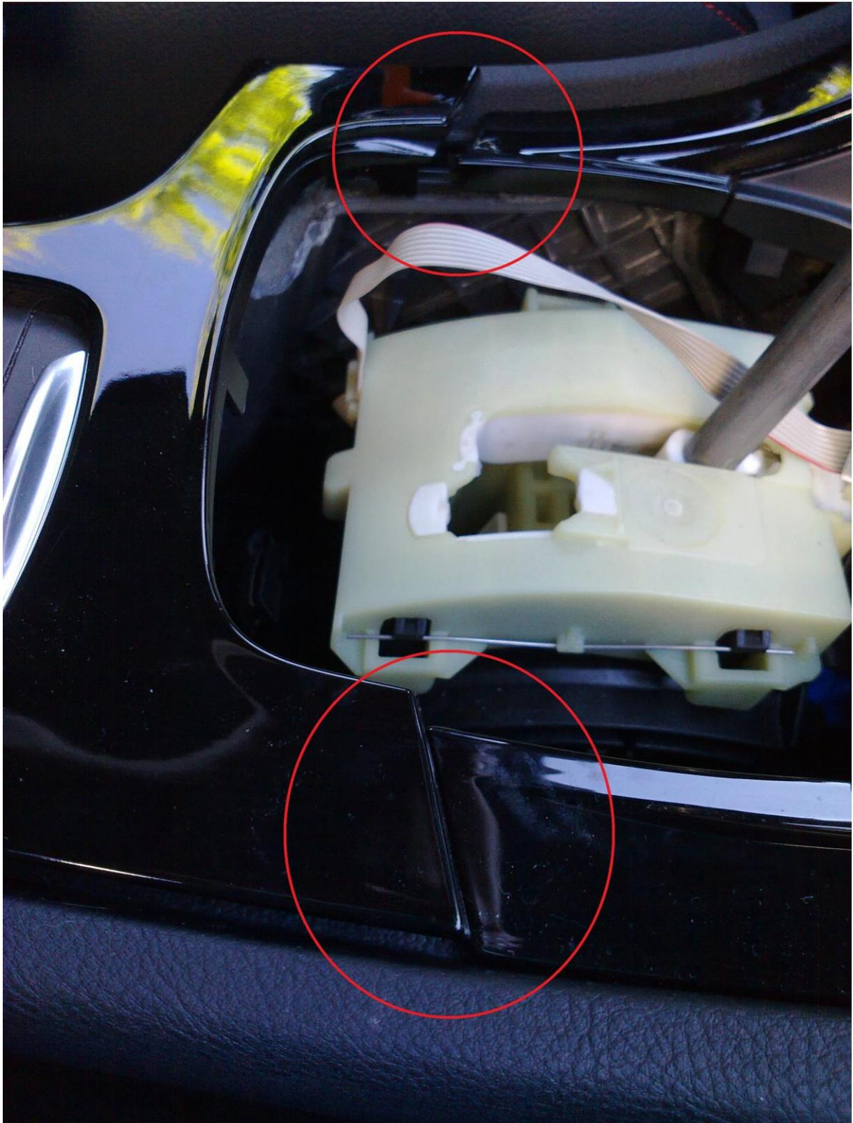
Zuerst den Getränkehalter ausbauen: Das Rollo etwas schließen und von hinten nach oben ziehen. Ist an 8 Punkten geklipst. Zum Rausnehmen das Rollo ganz schließen. Den Stecker für die Sitzheizung nicht vergessen!
