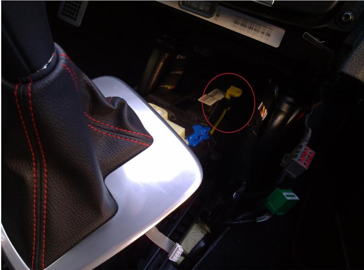
Jetzt das NX zu sich ziehen, die Stecker vom Startknopf, Scheibenheizung, PDC und Warnblinkanlage abziehen.
