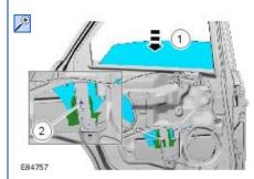
Schraube - Klemmschiene - Hintertürscheibe mit Zugangsbohrung - Fensterheber - Hintertür ausrichten.
