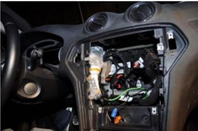
Das Klimamodul benötigt keine direkte Verbindung zum NX. Die Regelung der Klimaanlage erfolgt nach Einbau des NX ausschließlich über die Bedienknöpfe am NX.
