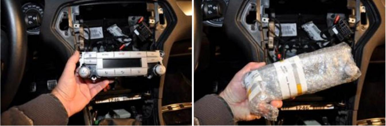
Bevor der Einbauschacht eingesetzt wird, das Modul hochkant links hinter dem Powerknopf verstauen.
