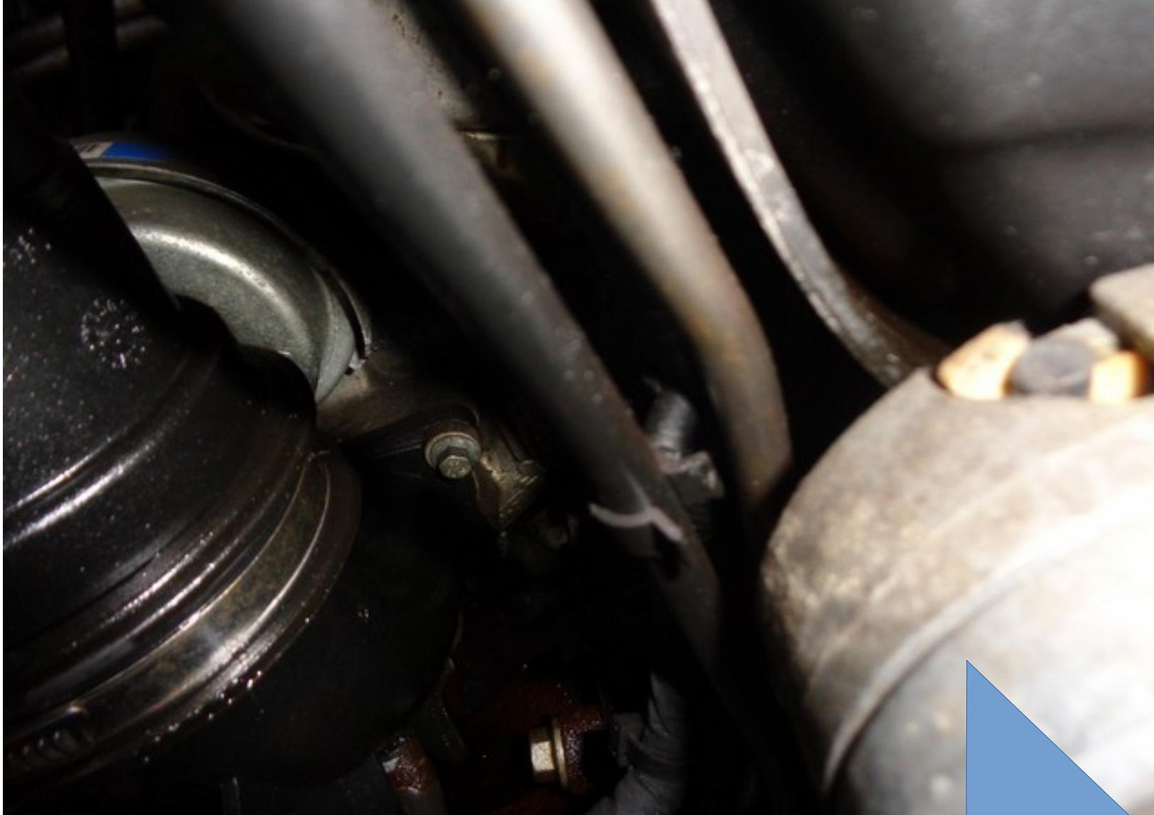
Motor Fahrerseite - ab dieser Verschraubung / Schelle für das dicke Rohr wird es nach unten ölig .
