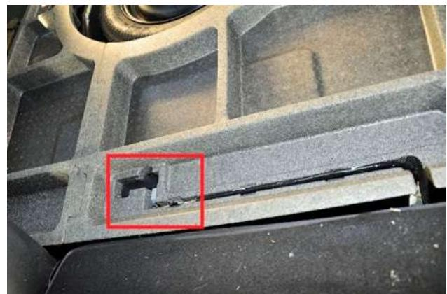
Zweiteilige Styroporeinlage entnehmen (sie ist vorn links und rechts mit Kleber angeheftet). Im hinteren Bereich alle Längs- und Querstreben mit dem Cutter rausschneiden. Siehe Markierungen
