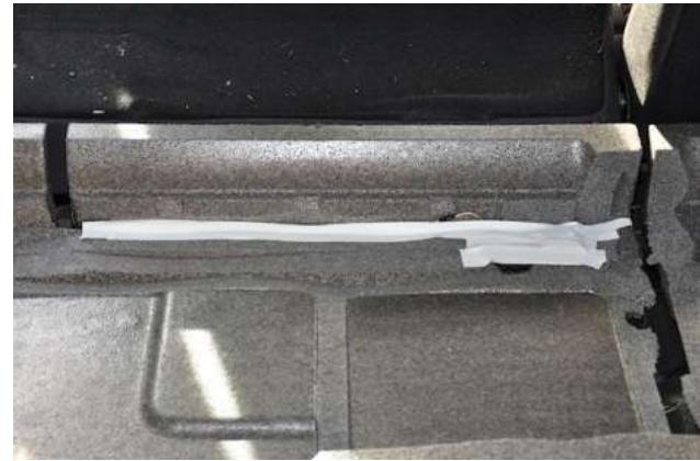
Im Bereich der Antenne muss der Styropor auch noch waagerecht etwas herausgeschnitten werden, weil dort die Antenne dort eingelegt ist und der Sub dort nicht tief genug stehen würde. Die Kabelführung muss ebenfalls vertieft werden, danach die Styroporeinlage wieder in den Kofferraum einlegen. Ich habe zusätzlich noch das Kabel der Antenne verklebt, damit es nicht am Subwoofer klappern kann, wenn der da drauf steht.
