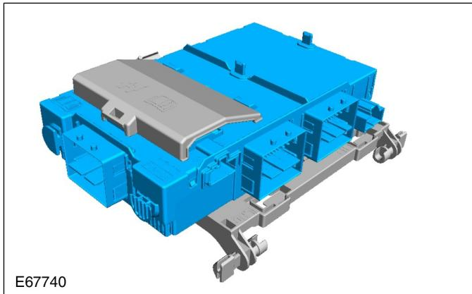
Bei einigen Fahrzeugen beinhaltet das GEM die PATS-Funktionalität. Hierbei erfolgt die Schlüsselabfrage vom GEM und die Sende-/Empfangseinheit ist direkt mit dem GEM verbunden.
