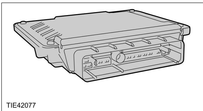
Das PCM bildet das zentrale Steuergerät für das PATS-System und greift bei allen Motoren in das Motorregelungssystem ein.
