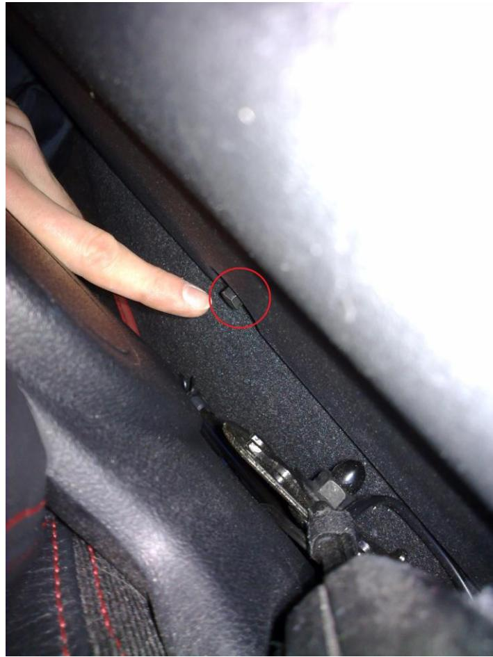
Nun die ganze Mittelkonsole hinten anheben und über den Bremshebel nach vorn / oben rausnehmen.
