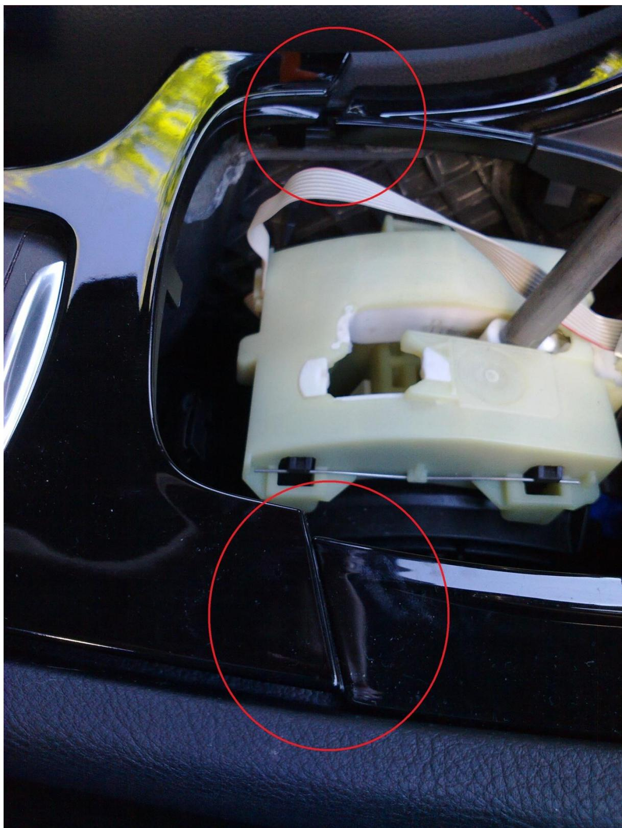
Zuerst den Getränkehalter ausbauen: Das Rollo etwas schließen und von hinten nach oben ziehen.
