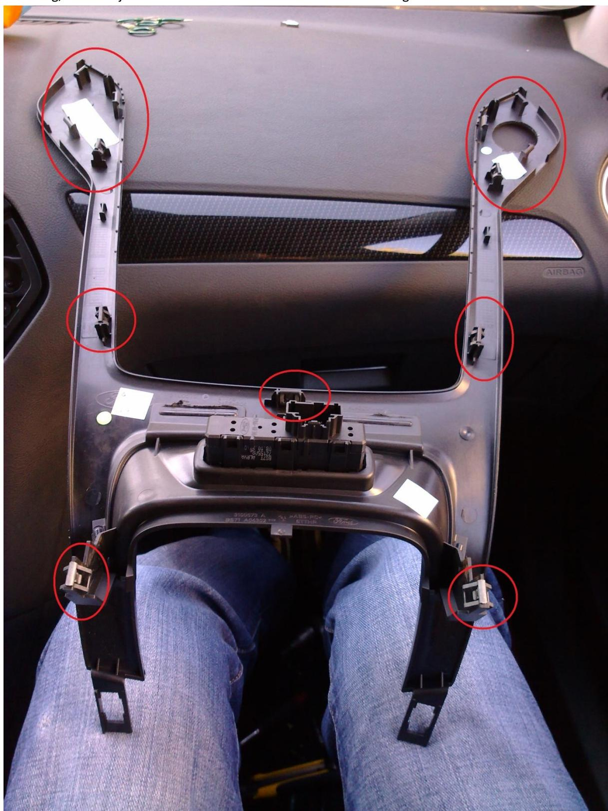
Jetzt im Fahrer und Beifahrerfußraum die beiden Blenden ausbauen. Mit einem Schraubendreher das Mittelstück herausziehen. Vorsicht, ist alles nur Kunststoff!
